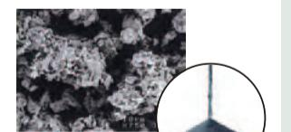
DOWA 開発の鉄粉はクロロエチレンに対しても高い分解性能を持つことを確認しています。
